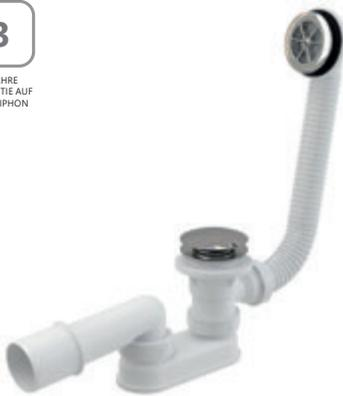
Der Siphon ist für die Minibadewanne Sabina konzipiert - mit Siphonöffnung und Überlauf (Ø 52 mm). Der Wasserablauf wird mithilfe des ClickClack-Systems gesteuert (drückt man auf den Siphon, wird der Ablauf gestoppt, durch erneutes Drücken wird der Ablauf wieder geöffnet).
