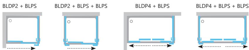
**Verwendungsmöglichkeiten:** Durch die Kombination einer feststehenden BLPS-Wand mit dem gewählten Duschtürtyp erhalten Sie eine quadratische oder rechteckige Duschabtrennung in unterschiedlichen Größen. Sie können unter den oben aufgeführten Kombinationen wählen.
