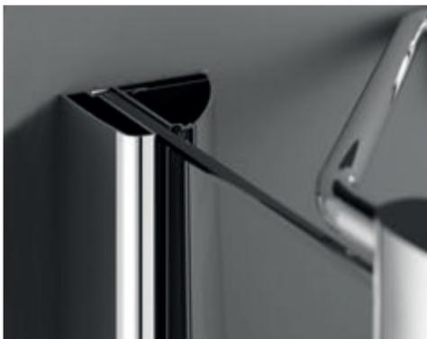
Befestigungsprofil – ermöglicht eine einfache und punktgenaue Befestigung und bietet Raum zum Nachjustieren. Kann eventuelle Bauungenauigkeiten von bis zu 15 mm ausgleichen.
