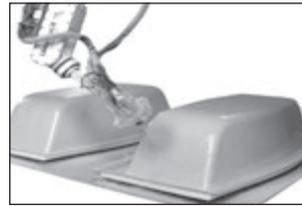
**Verstärkung des Presslings** Verstärkung des Presslings mit Harz – unter Zugabe von Glasfasern.
