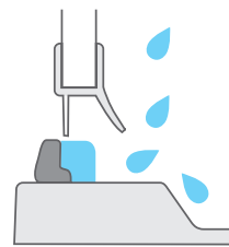
Dichtungsleiste im unteren Bereich der Kabine: Cool!, Brilliant, SmartLine, Matrix, Chrome
