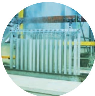
RAVAK Galvanik Eloxierung von Aluminiumprofilen - Herstellung der widerstandsfähigsten Profile für Duschkabinen, Duschtüren und Badewannenabtrennungen.
