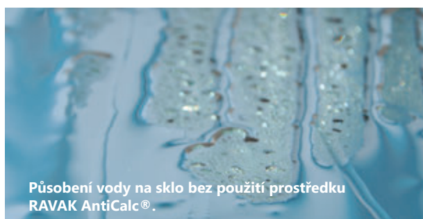
Sklo ošetřené prostředkem RAVAK AntiCalc® - voda je odpuzována a stéká po skle dolů.
